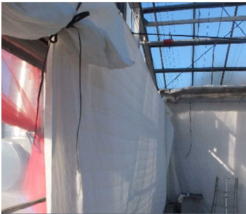
図1 断熱性の高い布団資材
