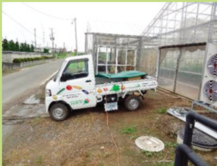
電気自動車からの温室への給電
