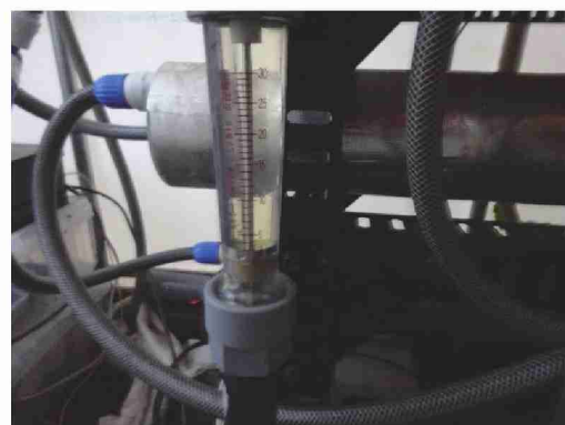
④洗浄 (30 分の浸漬) 後の流量計
