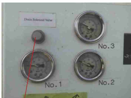
①圧カつまミを回し、0.5 MPa (5 kgf/cm 2 ) に合わせる
