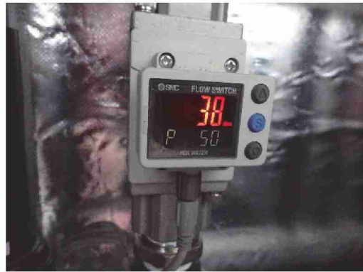
⑫排水量 30-40 L/min に調整
