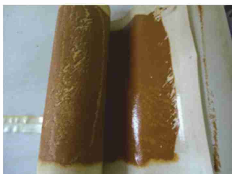
逆浸透膜フィルター内部の流路閉塞の様子
