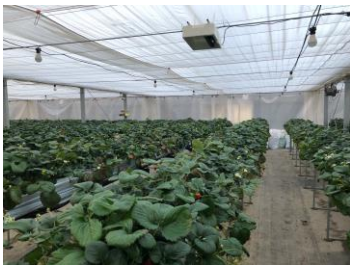
写真1 イチゴ群落上部に設置した3次元形状計測センサ
