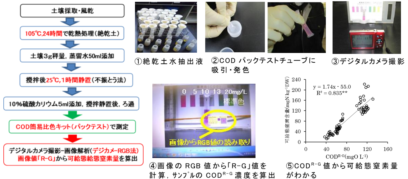
図1 測定の手順および画像から算出したCOD R-G 値と可給態窒素含量の関係
