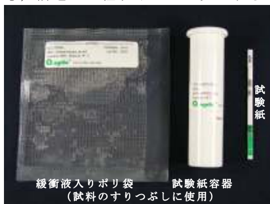
図1 ウイルス診断に使用する用具・試薬
