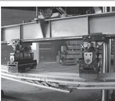
県産材CLTの強度試験状況
