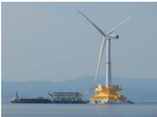
5MW風車搭載「ふくしま浜風」
