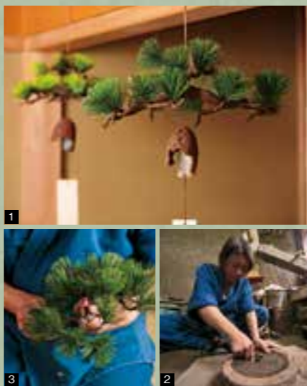
1.「一子相伝」の技が受け継がれる松笠風鈴 2. 鉄を流し込む型をつくる。砂と粘土の割合は、気温や湿度に合わせて手の感覚のみで調整する 3. 松の飾りも手づくりする。音色のグレードによって、使う飾りを変えている
