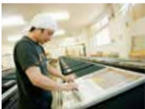
環境負荷の少ない水性印刷台が125面並ぶ。1枚1枚手刷りで制作していく
