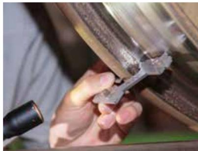
車輪の厚さを特殊な測定器具を使って計測し、ゆがみなどがいないか確かめる
