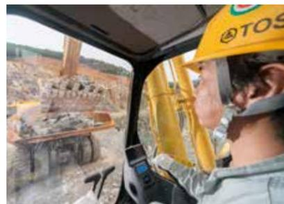
油圧ショベルを使って、同僚が運転するダンプに原石を積み込む作業を行う
