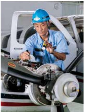
プロペラを動かすエンジンを覆うカバーを外して、エンジンの状態を点検する
