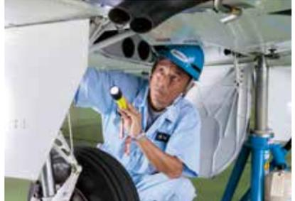
車輪の取り付け部分をライトで照らし、目視で状態を点検する
