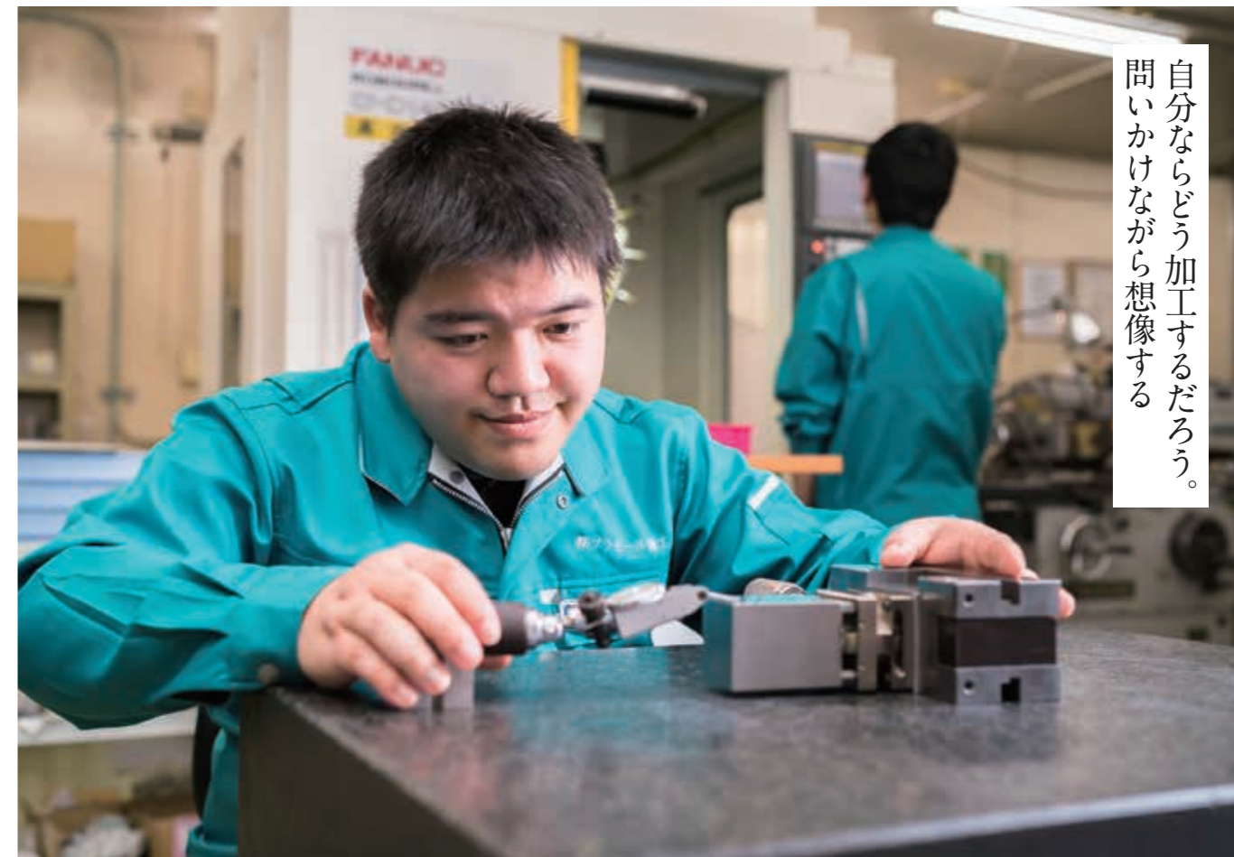
金型部品の機械加工に使う治具の調整をする本田衛さん
