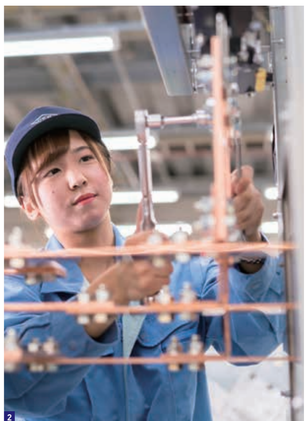
1 身長より高いキャビネットの中の交流分電盤を組み立てるのが、夏目さんの仕事。事前に図面を先輩とチェックする。担当の先輩社員とは常に連携を取りながら作業を進める
