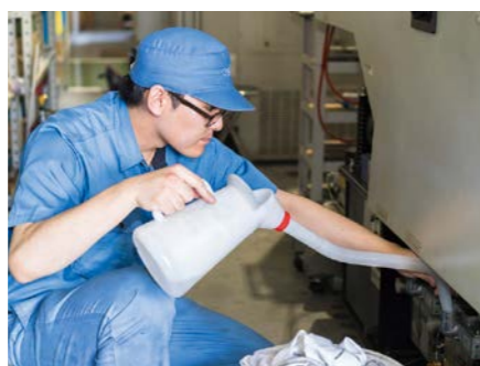
加工機にオイルを追加する。日頃のメンテナンスもオペレーターの大切な仕事
