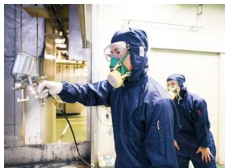
手吹き作業の練習。スプレーガンを使って直接塗装を施す
