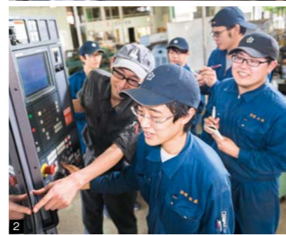
①汎用フライス盤で機械加工を学ぶ金属加工科の訓練生。②入力したデータをもとにマシニングセンターが自動で金属を加工する様子を確認する訓練生
