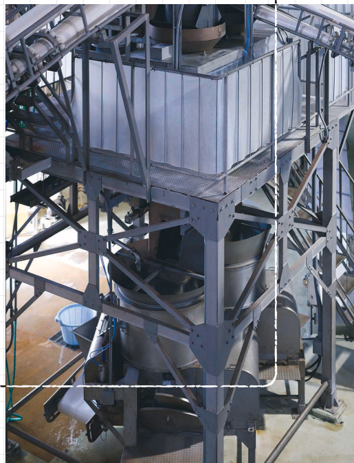
3点混合機でみその基となる麹、大豆、塩を混ぜ合わせる
