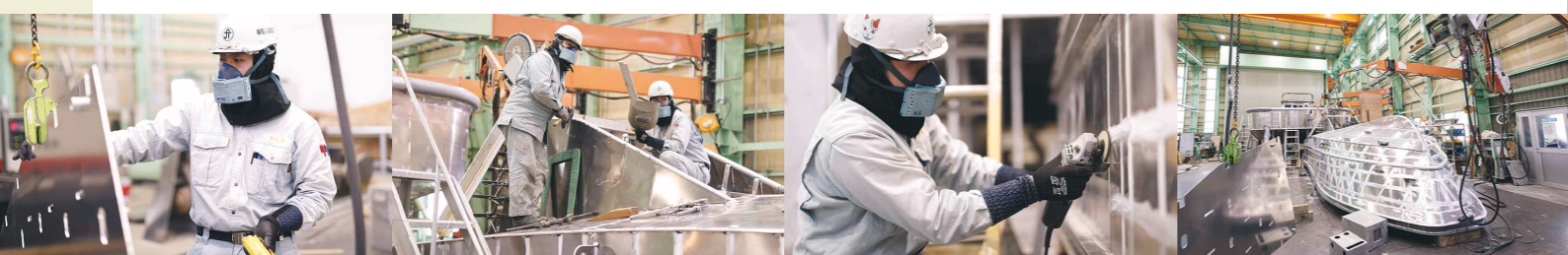
a: 切り出したアルミ板を慎重に運ぶ本木さん b: 溶接は高い集中力を持って丁寧に行う c: 研磨機でアルミの表面をきれいに磨いていく d: 1艘のアルミ船を作るのに長いと4カ月程度かかる
