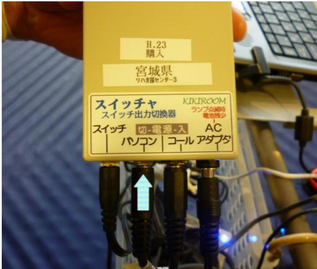
青矢印の「スイッチャ」のパソコンポートに「なんでもスイッチUSB」に接続した3.5mmミニプラグを接続する。
