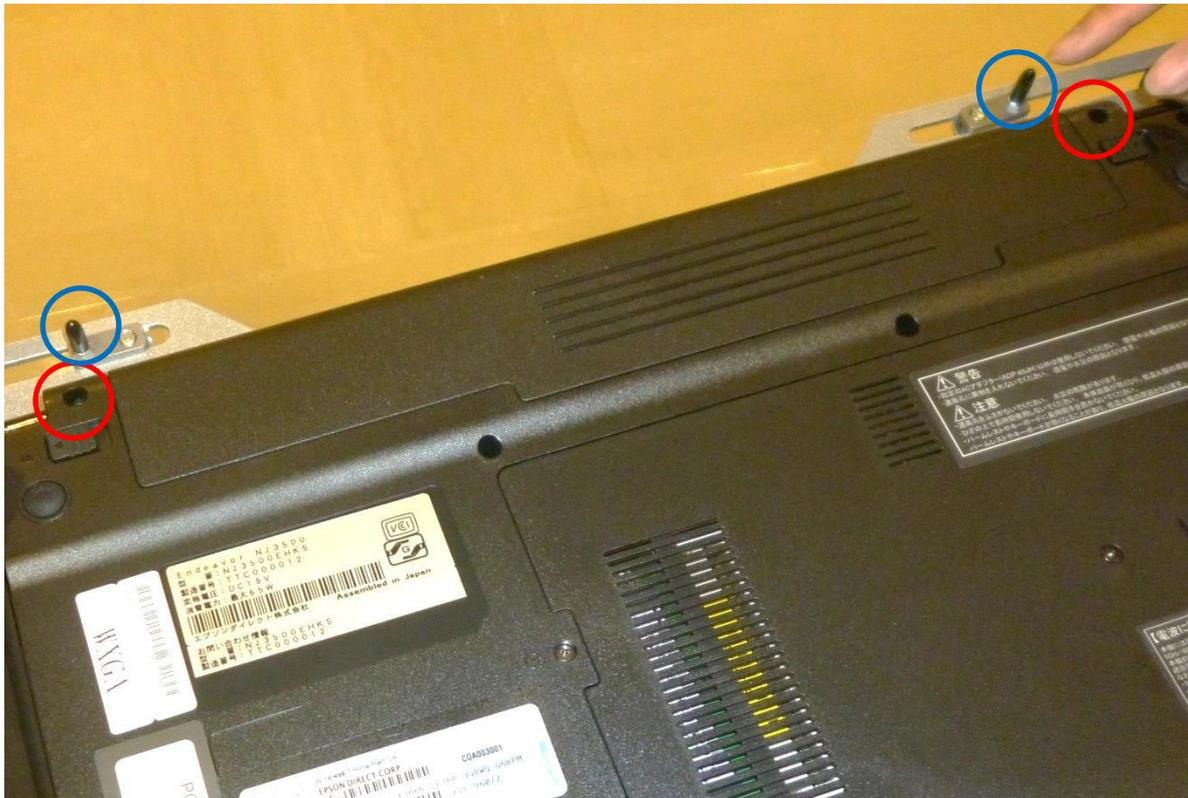
伝の心本体の裏側にある赤丸で囲っている**2つの穴**と青丸で囲っている**ストッパーボルト**を合わせて固定する。
