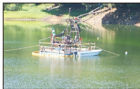
嘉太神ダムにおける実施設計のためのボーリング調査
