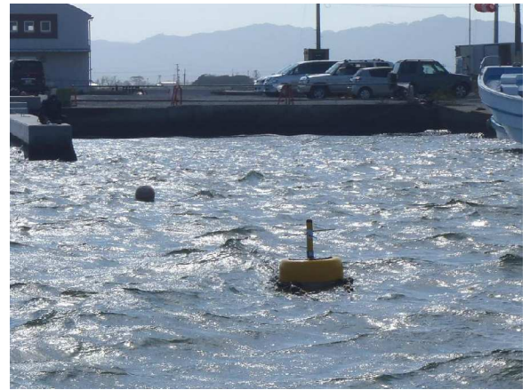
荒浜の水温自動測定ブイ
