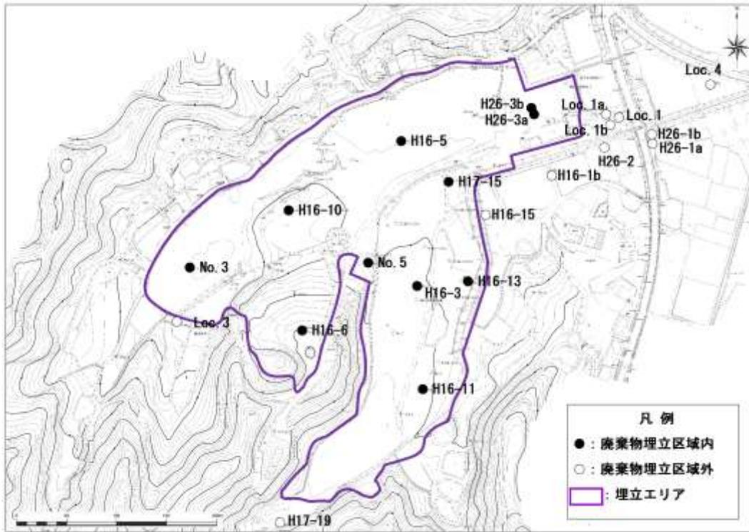
図V 地中温度及び地下水位調査地点図
