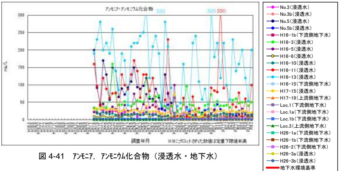
図 4-41 アンモニア、アンモニウム化合物 (浸透水・地下水)
