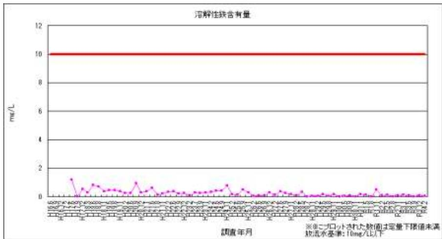
図 2-20 溶解性鉄含有量（放流水）
