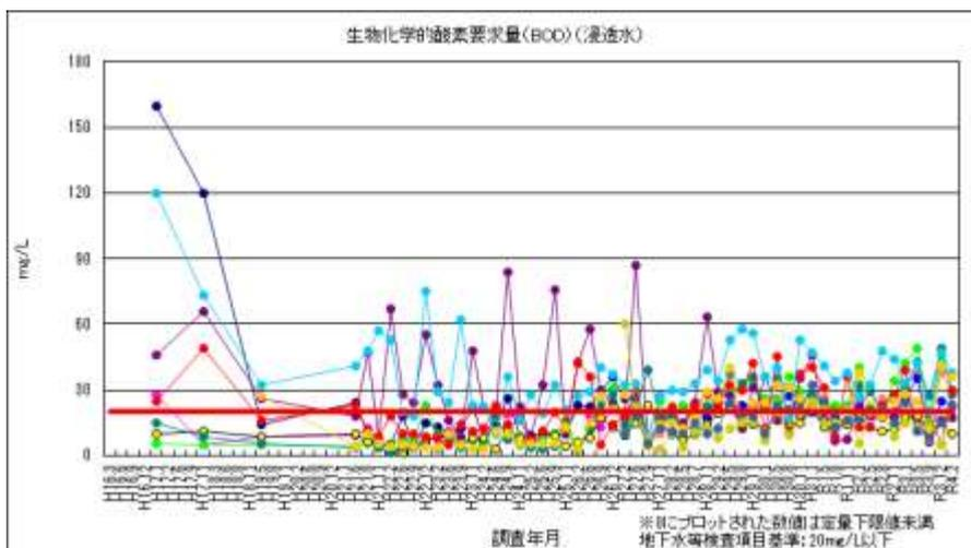
図 4-33 生物化学的酸素要求量 (BOD) (浸透水)
