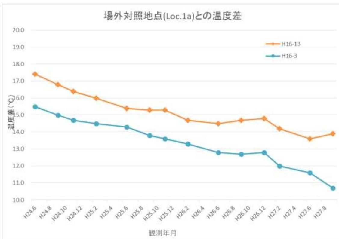
図 5-2 処分場内高温部と対照地点（Loc.1a）との温度差の変化
