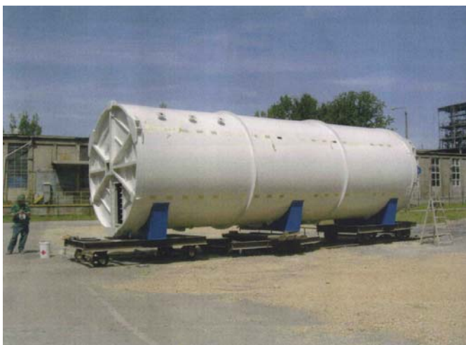
県南浄化センターに設置される乾燥炉
