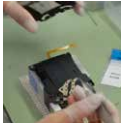
シャッター組立工程
