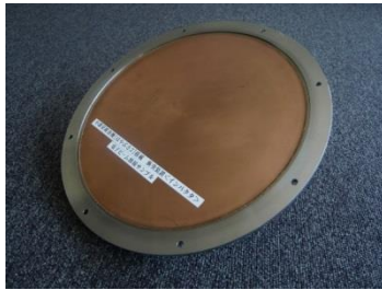
《①電子ビーム溶接サンプル》 はやぶさ2搭載「インパクト」(Cu1020+SUS304)
