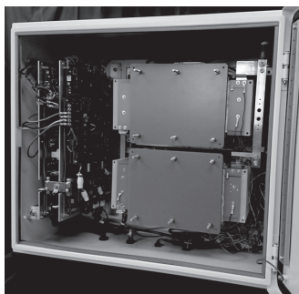
▲開発中のパワーコンディショナレス クリーンエネルギー蓄電装置の試作品
