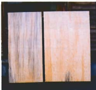
写真1. 被害材LVLパネル
