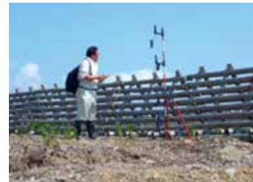
写真 防風フェンス内における風速・風向調査
