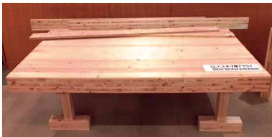
写真 CLTの試作①（セイホク（株）及びセイホクプライ（株）の取組） →平成28年4月にCLTのJAS認定取得（全国で5番目）
