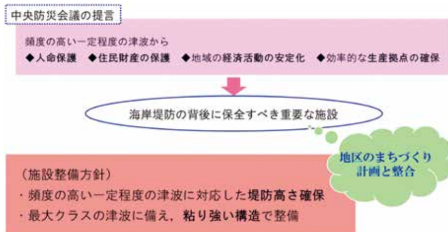
図 東日本大震災における海岸施設復旧の考え方（対策方針）
