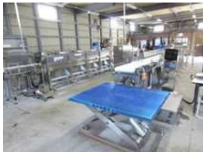
石巻魚市場に設置された連続個別非破壊放射能測定システム(簡易検査用)
