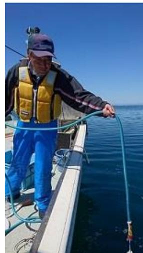
左図：バンドン採水器による層別採水の様子（従来行ってきた方法）
