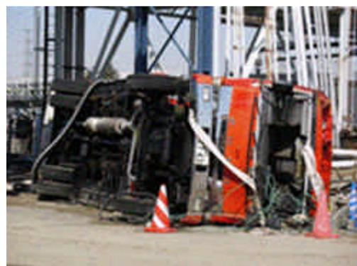
図 5.1.15 津波による消防車両の被害
