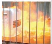
噴射剤に可燃性ガスを使用しているスプレー缶をファンヒーターの前に置いたところ、熱で膨張して噴き出たガスが引火しました。(再現実験)
