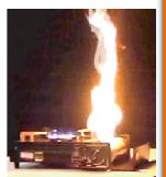
カセットボンベを正しく装着 しなかったために漏れたガス が引火しました。(再現実験)
