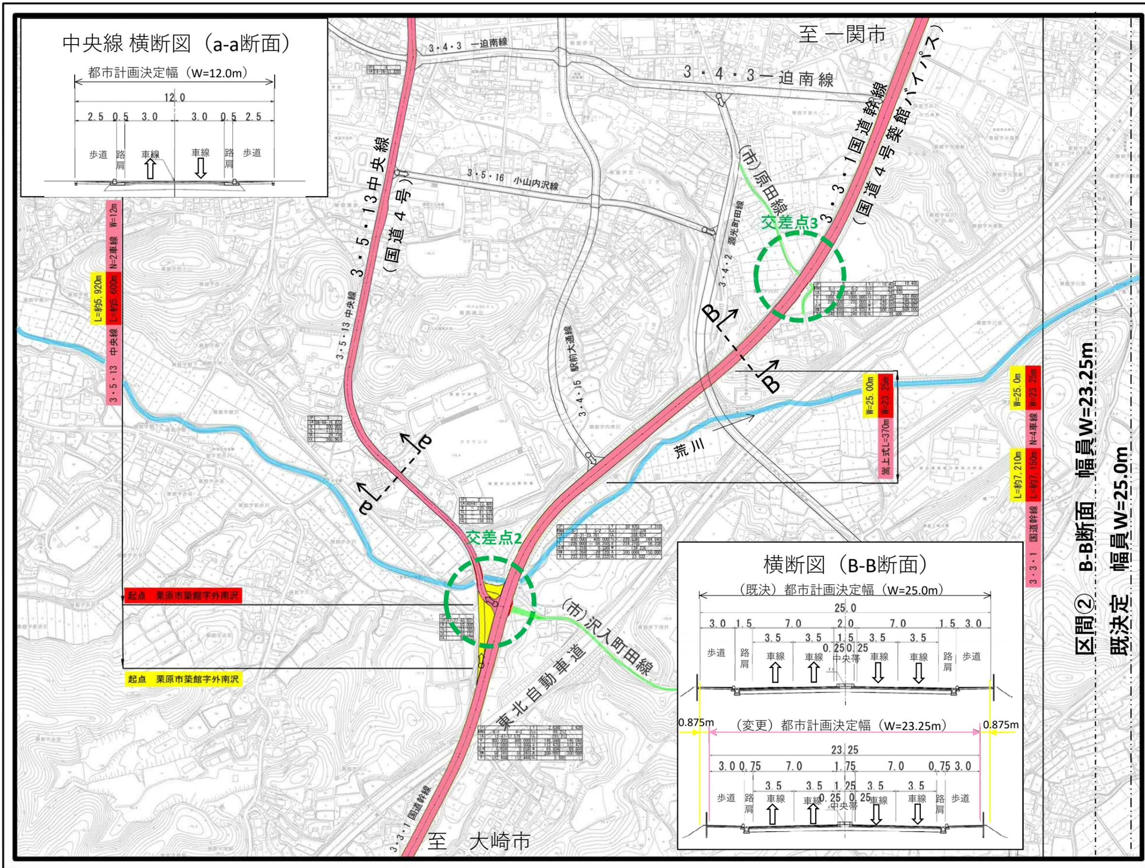
中央線 横断図 (a-a断面)
