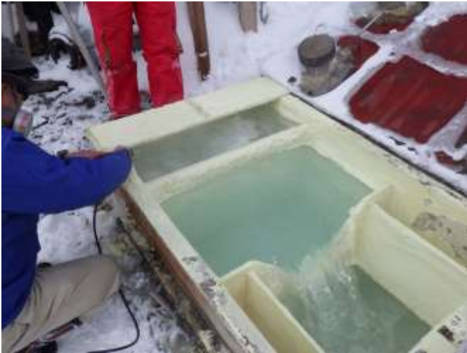
貯湯槽底部のガス測定
