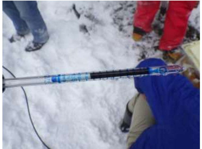
左写真貯湯槽の測定結果 硫化水素濃度 17 000 ppm
