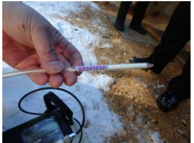
左写真貯湯槽内部のガス測定 二酸化炭素濃度 87vol.%
