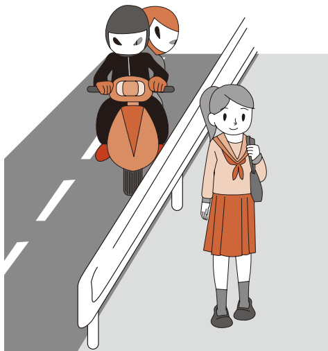
ガードレールで歩道と車道を分離
