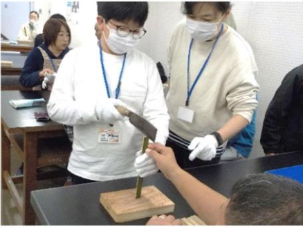
竹箸作り。ナタで割って、小刀とヤスリで削って、完成！
