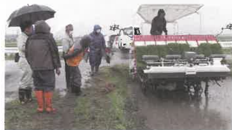
雨の中実施した、ペースト二段施肥機での田植（5月）
