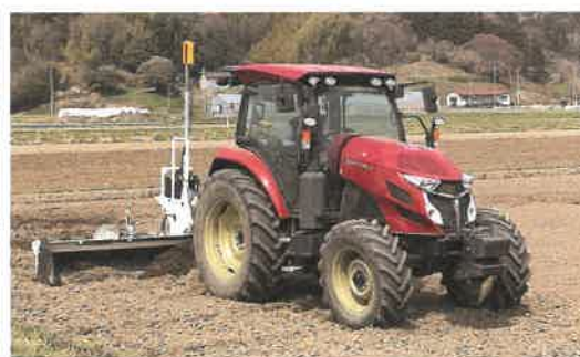
レーザーレベラーによる均平作業
