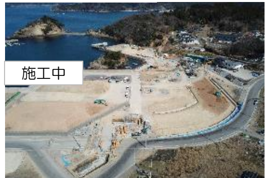
④ 荻浜港有田浜地区防潮堤工事 施工延長 L=172m
