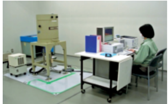
ゲルマニウム半導体検出器による測定
