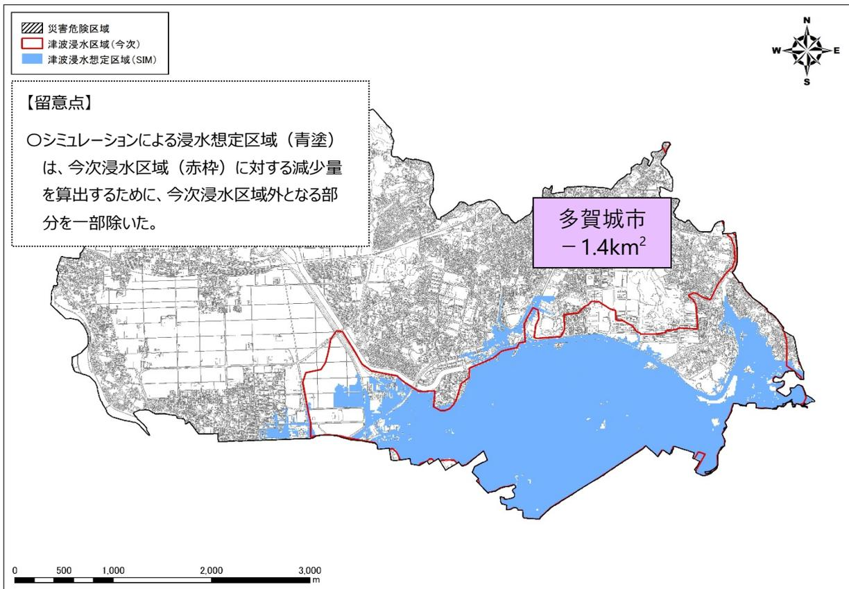
図-3.19 今次津波と津波防護施設整備後の浸水区域（津波 SIM）の比較（塩竈市、多賀城市）
