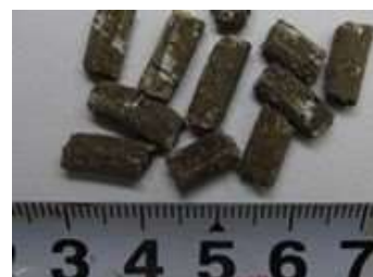
図3 使用した混合堆肥複合肥料の外観 長さ8～12mm、径5～6mm程度
