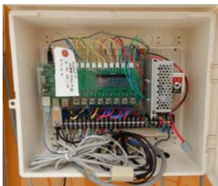
図2 低コストDIY型環境制御システム（商品名：Arsprout DIYキット）の制御ノード（内部）
