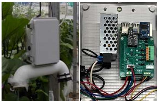
図3 低コストDIY型環境制御システム（商品名：Arsprout DIYキット）の内気象ノード（左：外観, 右：内部）
