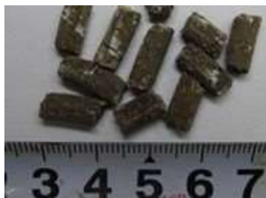
図 1 使用した混合堆肥複合肥料ペレットの外観 (長さ 8～12mm, 径 5～6mm 程度)
