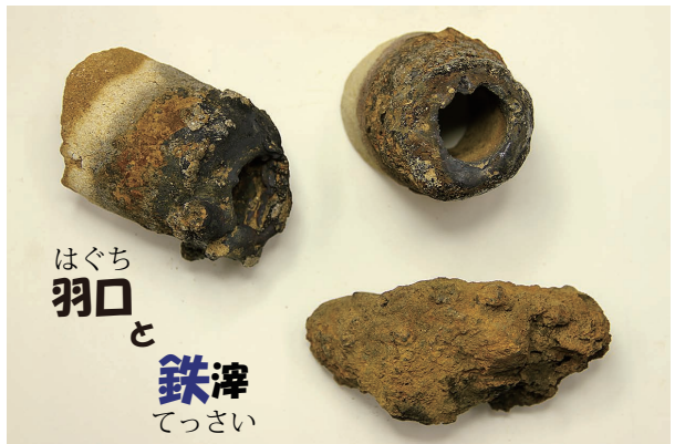
写真 18 羽口は炉に風を送る土製の管、鉄滓は炉の底にたまった不純物のかたまりです。
