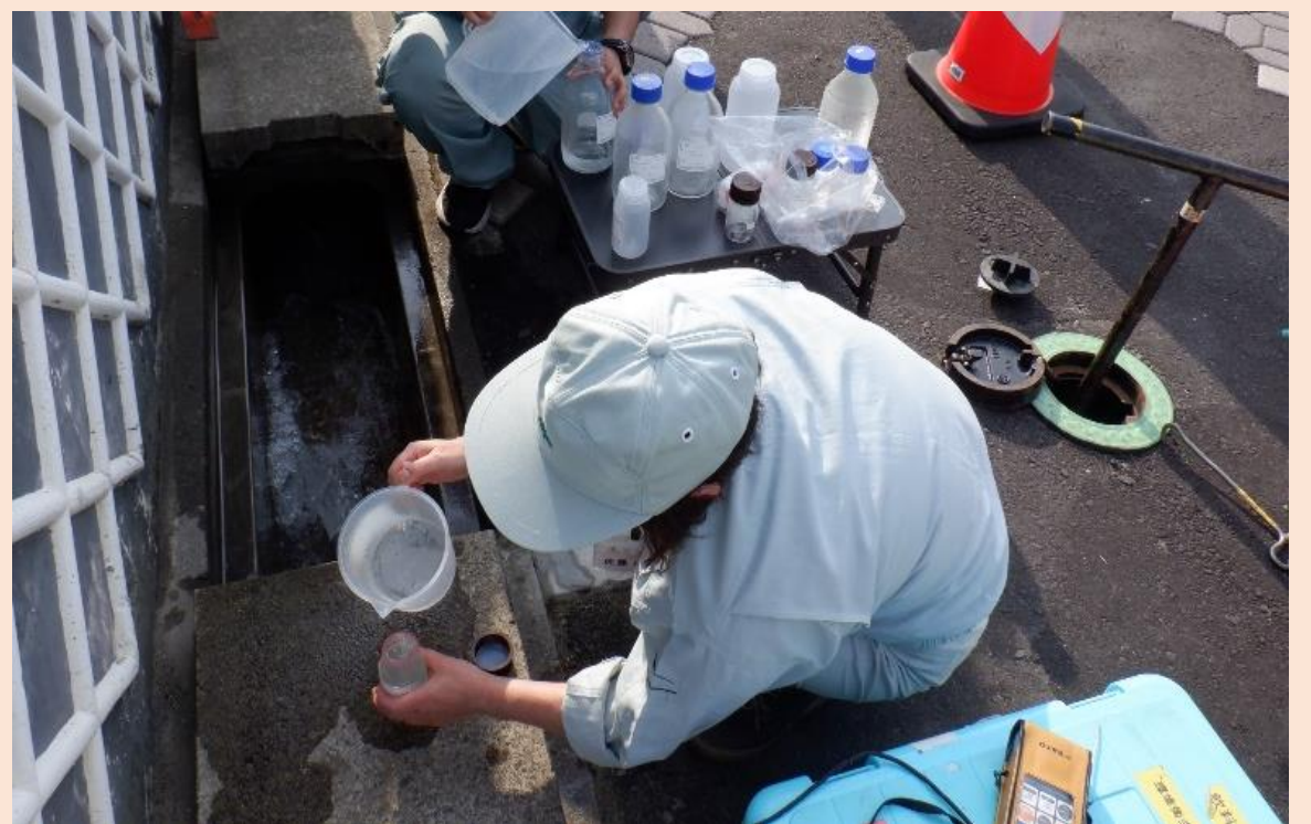
管路更新による通水切替えに伴う採水・水質検査状況
