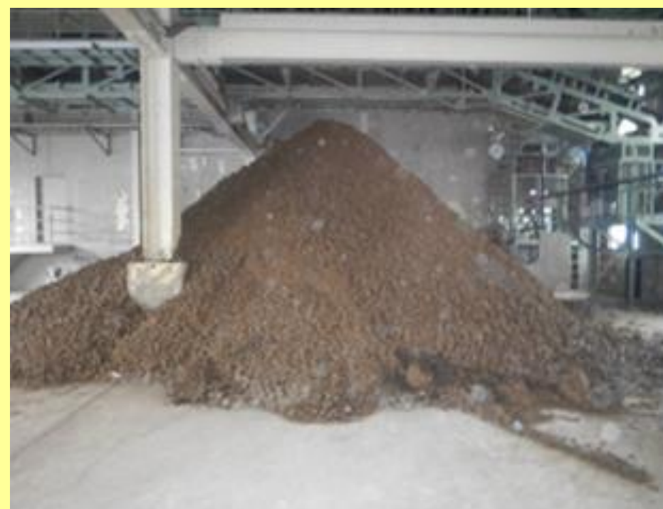
麓山浄水場脱水処理後の発生土状況
