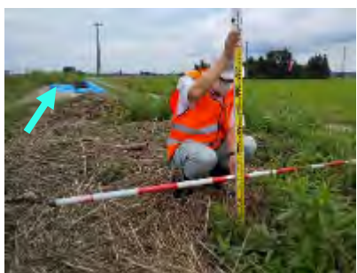
越水写真(痕跡)
