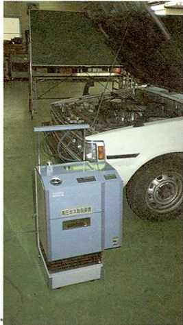
カーエアコンに使われているフロンの回収・再生
