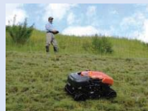
無線草刈機の運用に対応した傾斜
