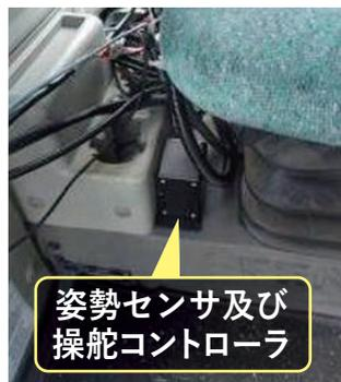
自動操舵装置は、衛星からの信号を受信するためのアンテナ、受信機、表示器、姿勢センサ、操舵コントローラ、操舵モータで構成されています。
