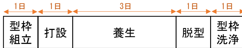
図 3-3 コンクリートブロック製作サイクル
